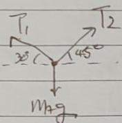
$$F_x = T_2 \cos 45^\circ - T_1 \cos 30^\circ = 0$$
