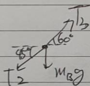
$$F_x = T_3 \cos 60^\circ - T_2 \cos 45^\circ = 0$$
